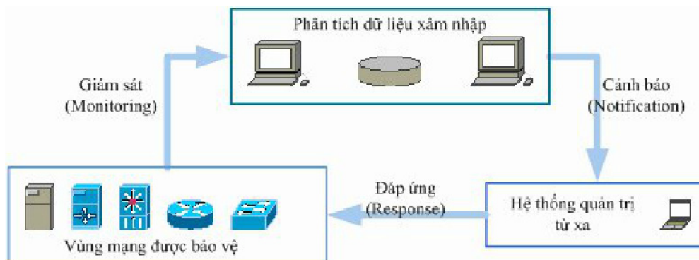
Hình 3.2 – Hạ tầng hệ thống IDS
