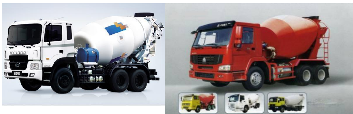
Xe trộn bê tông
